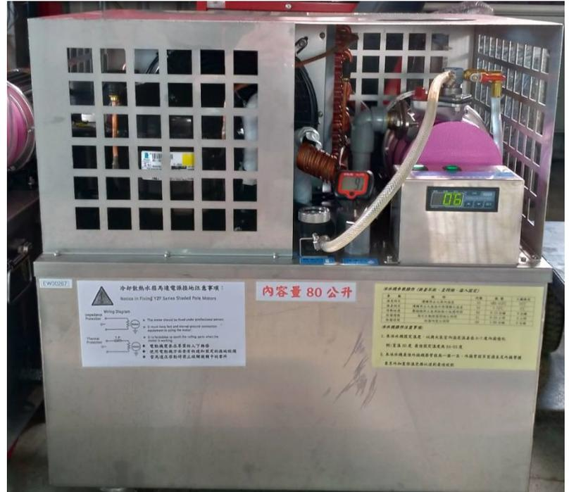
冰水機用途：輪鐸機、點鐸機、油壓、熱溶模具、大功率鐸接切割冷却散熱設備操作專用、採用不銹鋼馬達、不銹鋼內膽、水容量 80L、不銹鋼正 304#、出水容量每分鐘 20L~30L。冷凍能力 7500BTU.溫控器採新型、設定操作簡便有效、更穩定、水容量更大、內冷凝器加大、製冷度更快、冷却效果更佳。
